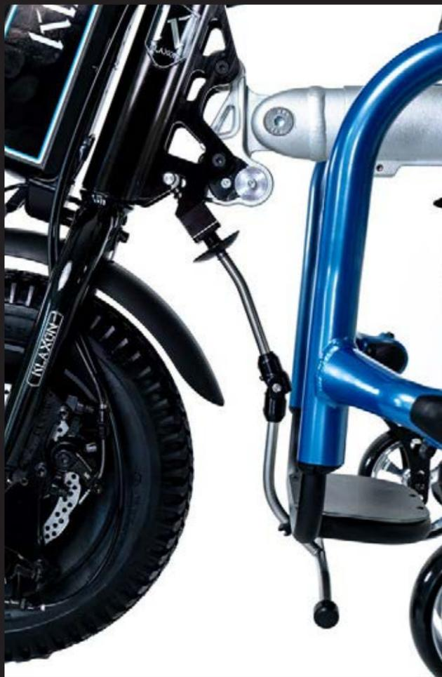
1. Der Ständer passt sich automatisch an den Rollstuhl des Benutzers an und muss beim Ankoppeln oder Parken nicht manuell eingestellt werden, da er bereits in Position ist. Für den Transport im Auto, Flugzeug oder Zug kann er mit einem einfachen Druck entfernt werden.
